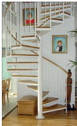
"Huvila"-pinnakaiteessa pystypinnat päätyvät käsijohteen suuntaiseen teräspintaan. Kaidetolpat \varnothing 26,9 mm ja pinnat \varnothing 12 mm.
